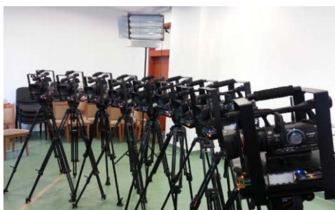
Rys. 4. Eksperymentalny system telewizji swobodnego punktu widzenia wybudowany na Politechnice Poznańskiej
