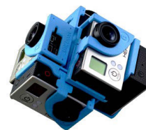
Rys. 2. Przykładowa kamera dookólna zbudowana z 6 kamer szerokokątnych
