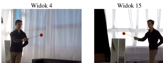
Rys. 4 Wyznaczanie parametrów zewnętrznych sekwencji Choreo z użyciem prostego znacznika.
